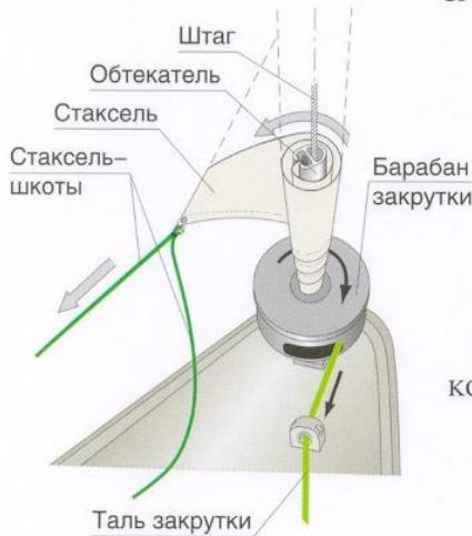
Передняя шкаторина стакселя вставлена в ликпаз обтекателя с барабаном внизу и вертлюгом вверху, которые жестко соединены и имеют свободное вращение относительно штага. На барабане закреплена таль закрутки, ходовой конец которой проведен в кокпит. Выбирая таль закрутки, можно стаксель намотать вокруг обтекателя полностью или частично.
